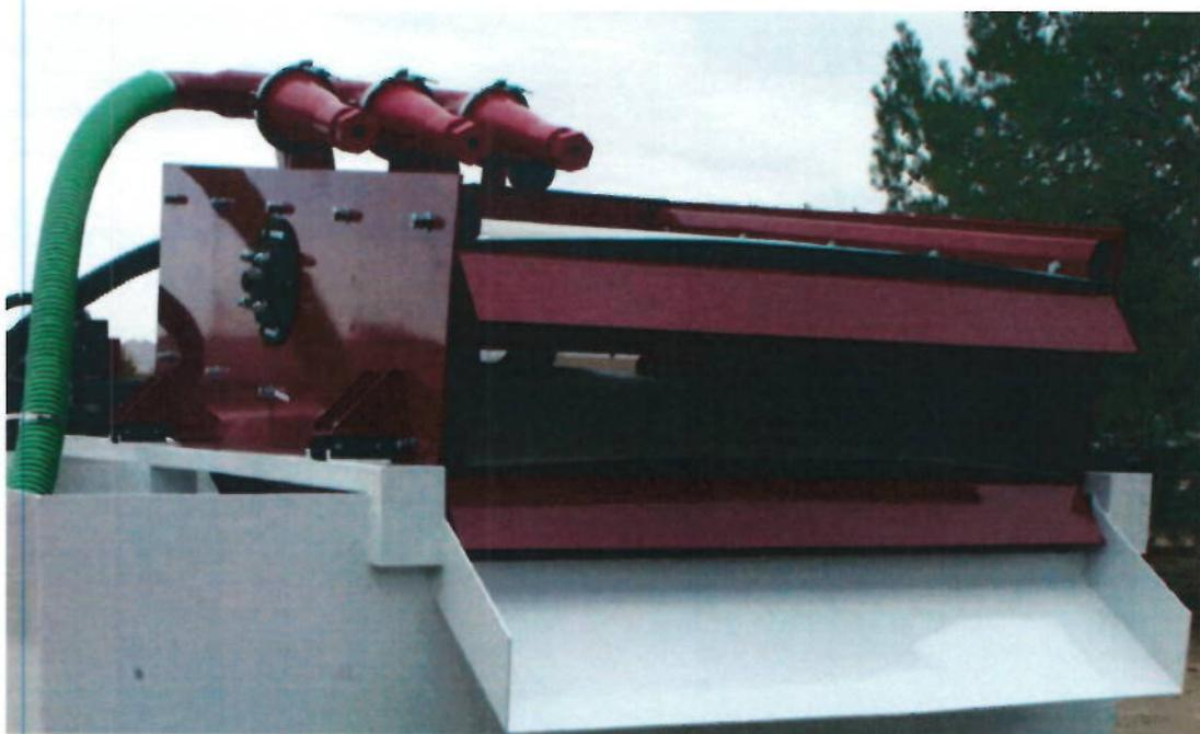
После того, как раствор перемешался, закройте клапан смесительной воронки и откройте клапан пескоотделителей, расположенный в верхней части насоса. раствор начнет поступать в пескоотдели-
